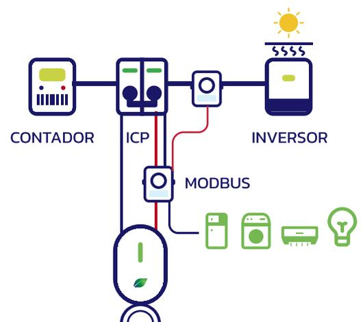
El modelo evOptima ha sido diseñado para cargar el vehículo eléctrico a través de tu sistema fotovoltaico.
